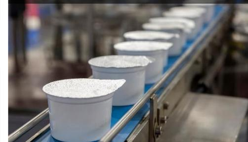
製品は、適切な包装材料を使用して梱包され、トレーサビリティ確保のためラベルやコードが付けられます。包装は製品の鮮度維持や安全性確保に重要な工程で、密封状態が保たれているか視覚的または機械的に検査します。また製品を一定数ずつ箱詰めする作業ではロボットによる自動化が進められています。
