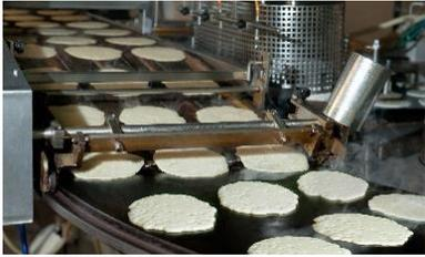
パンケーキ焼成時に小さい粒となった生地が付着すると、黒く焦げた異物のように見えます。コンベア上を流れる焼成後のパンケーキを3Dセンサーで撮影し、異物を検出します。2Dカメラでは焦げ目があった生地と異物との判別が難しいケースがありますが、3Dセンサーで撮影することで凹凸の異物のみを判別することが可能です。
