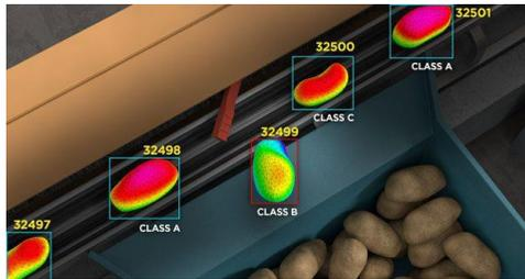
サイズや形状によって用途が変わるジャガイモの判別では、膨大な量を短時間で選別するため高速な処理判断が要求されます。3DセンサーGocatorは高速搬送されるじゃがいもをリアルタイムに3D計測し、長さや体積に基づき、用途別に分類します。またパーツ検知機能でジャガイモ1個1個の領域に自動的に分割し、内蔵の計測ツールを使用して体積や縦横比を計測します。
