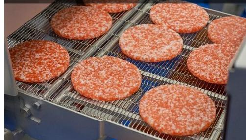
原材料は所定のレシピに基づいて混合・加工されます。製品によってはクリーンルームを導入して製品の衛生状態を維持します。自動化ラインではカメラやセンサーを使用して、外観、充填量、個数などを自動検査し、不良が検出された場合は即座に対処します。
